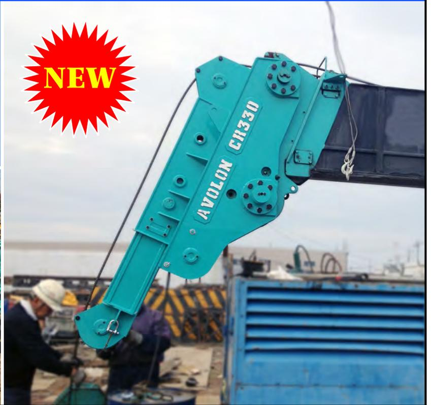
ケーシング引抜工法等に最適な施工機械です。
